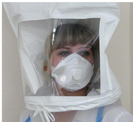
根据灵敏度测试期间雾化器“喷射”的次数，适合性测试开始时使用测试溶液雾化器（更高的浓度）喷射相同的次数，然后每30秒喷射一半的次数，以此保证测试剂气溶胶在头罩内保持稳定的浓度。
